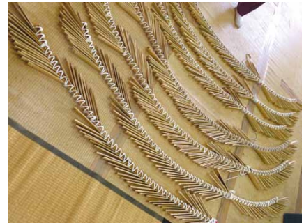
クサビを打って弓の曲線を作る (この時は、弓を引く時の逆方向に曲げる。)
